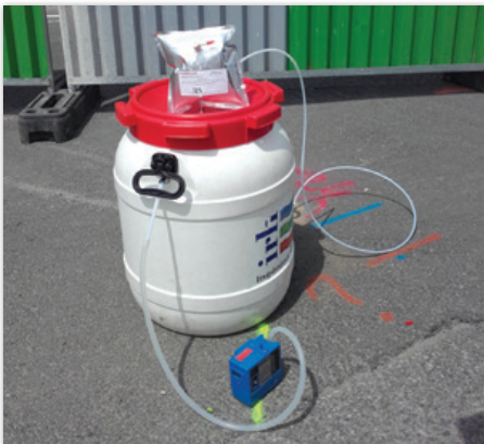
Prélèvement de gaz de sol selon le protocole n°2
