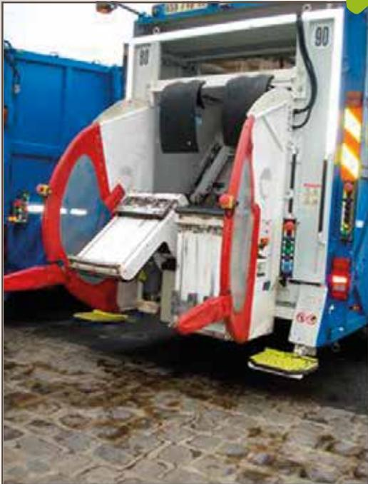
Des écrans latéraux bien dimensionnés permettent d'éviter que les ripeurs puissent accéder à la zone de manœuvre et au lève-conteneur pendant la manœuvre.
