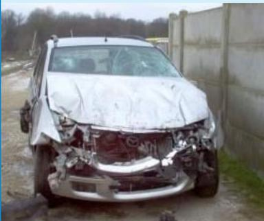
*En raison d'une visibilité réduite due au mauvais dégivrage de son pare-brise, le véhicule léger a heurté la benne par l'arrière entraînant la mort d'un équipier.*
