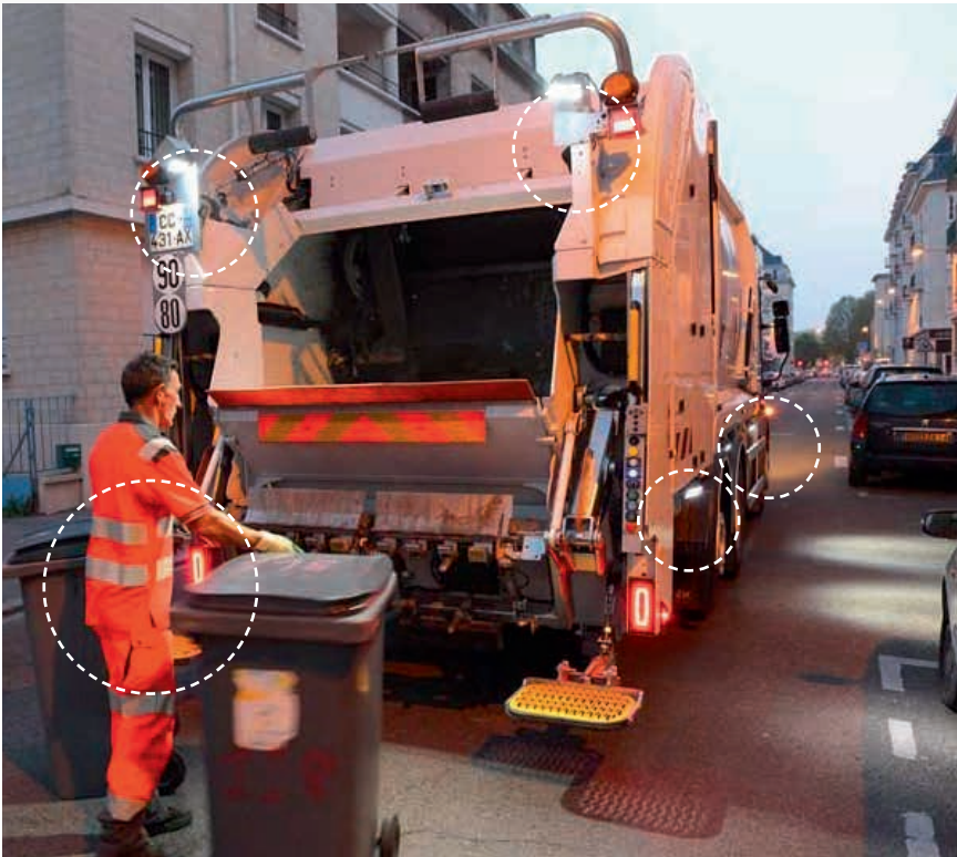
Voir et être vu : l'éclairage de travail arrière, obligatoire selon la norme EN 1501-1, peut être utilement complété par un éclairage latéral droit afin de répondre aux obligations d'éclairage de la zone de travail.
