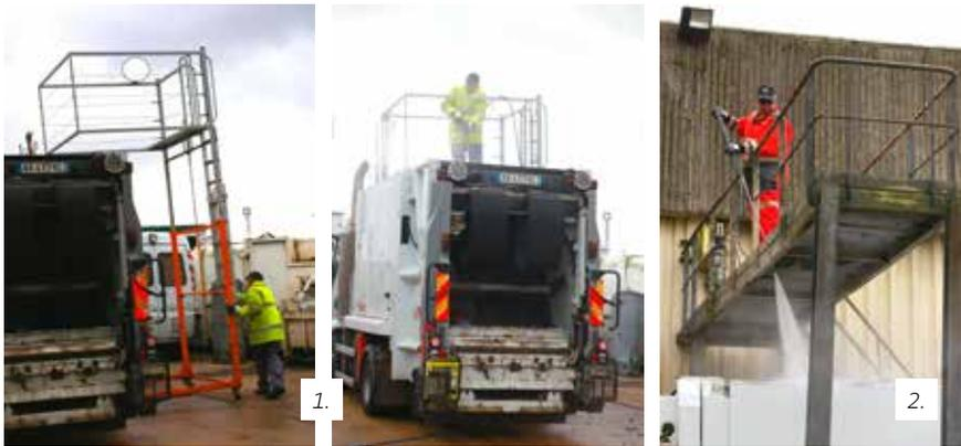
Exemples de plateforme pour le nettoyage en hauteur (1. mobile - 2. fixe)
