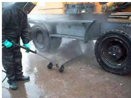
« Montée sur roues, elle permet le nettoyage des châssis des matériels roulants en toute sécurité et en réalisant des économies d'eau. »
