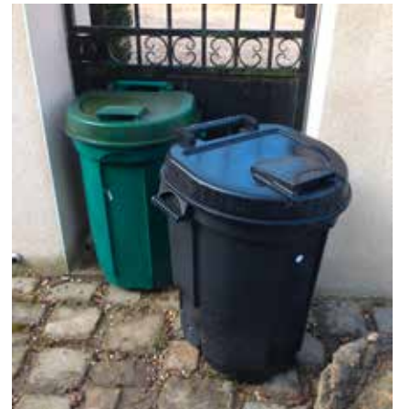
Exemples de bacs qui ne peuvent pas être appréhendés par les lève-conteneurs
