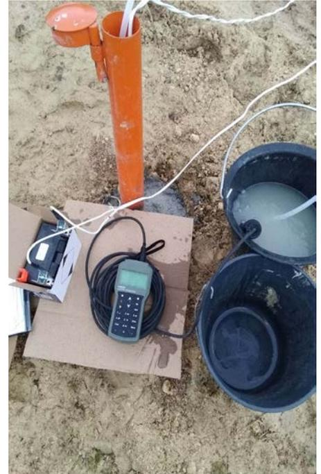
Figure 2 - Prélèvement d'eaux souterraines
