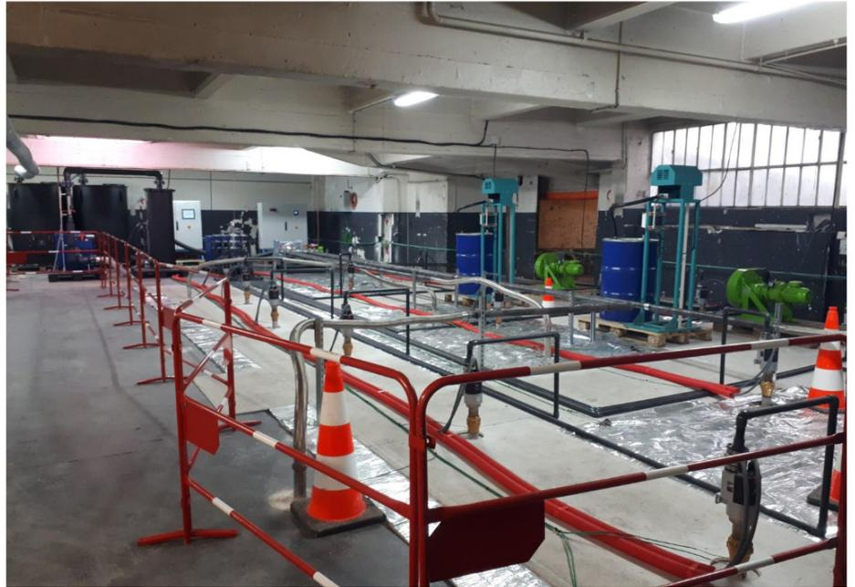
Figure 3 - Photographie du dispositif de traitement des sols / écrémage nappe de la zone d'étude
