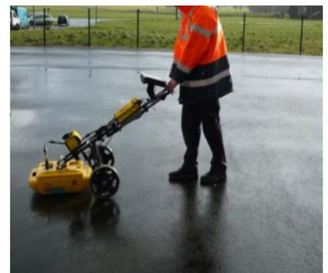
Figure 2 – Exemple de radar à pénétration de sol (GPR)
