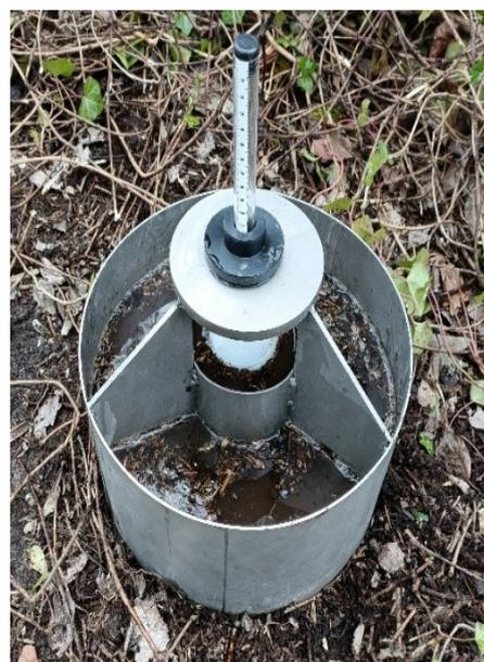
Illustration 1 Évaluation de la perméabilité des sols de surface au perméamètre double anneau.
